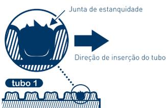
Colocar a junta de estanquidade entre a primeira e a segunda corruga da ponta macho do tubo. Os lábios da junta de estanquidade devem estar na direção de facilitar a introdução do tubo, tal como representado na figura.
